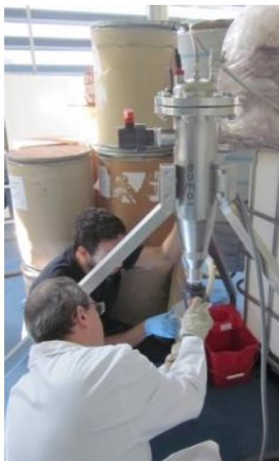
Figura 3. Detalle del equipo de pretratamiento de ultrasonidos.
