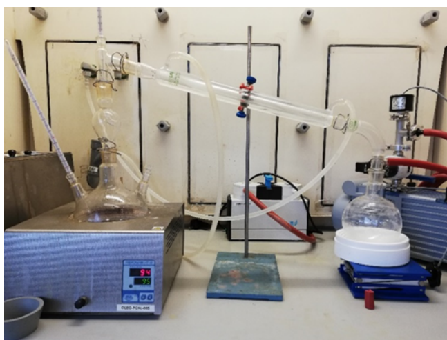
Imagen 1. Equipo de laboratorio para llevar a cabo la destilación de biodiesel.
