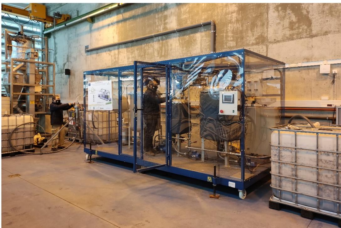
Figura 6. Planta piloto de digestión anaerobia con pretratamiento de ultrasonidos
